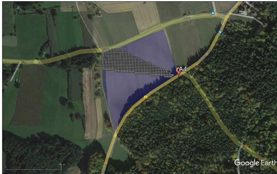
Abbildung 23: Spezifischer Emissionsbereich für Punkt A4 auf der Bundesstraße (Modulneigung 15°)
