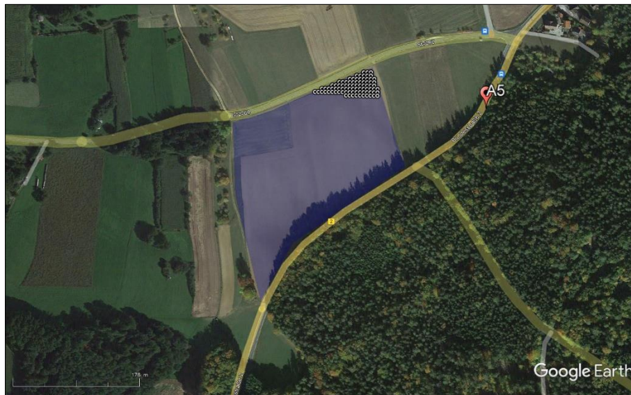
Abbildung 24: Spezifischer Emissionsbereich für Punkt A5 auf der Bundesstraße (Modulneigung 15°)
