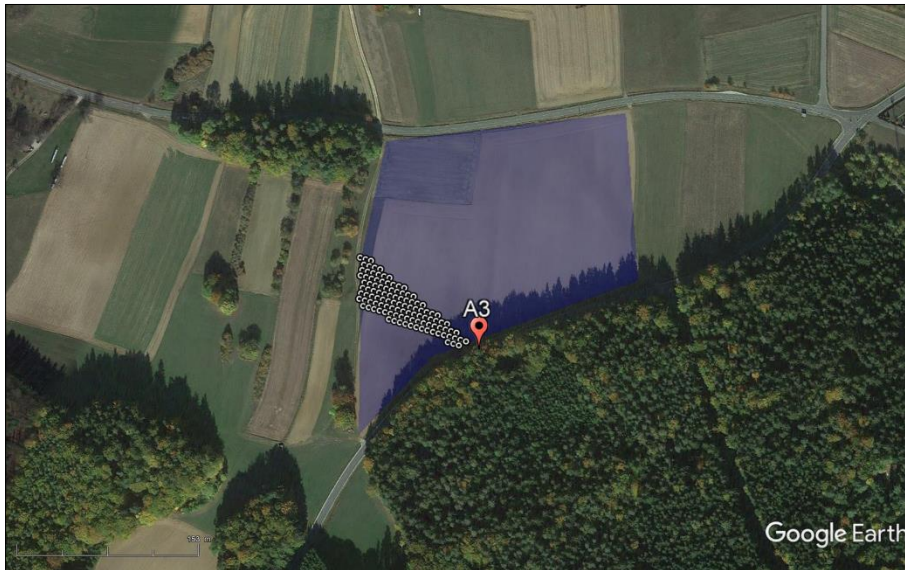
Abbildung 14: Spezifischer Emissionsbereich für Punkt A3 auf der Bundesstraße (Modulneigung 20°)
