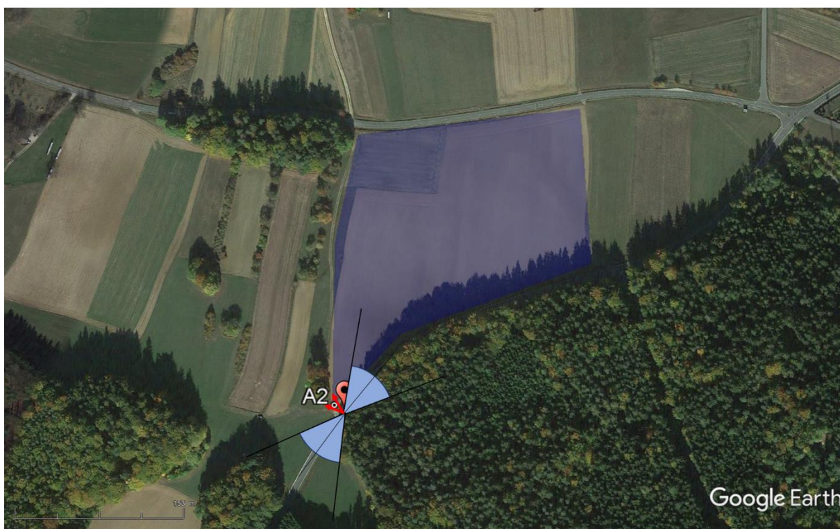
Abbildung 25: Vergleich Sichtfeld Fahrzeugführer für Punkt A2 mit Grenzvektoren in Richtung Module (Modulneigung 20°)
