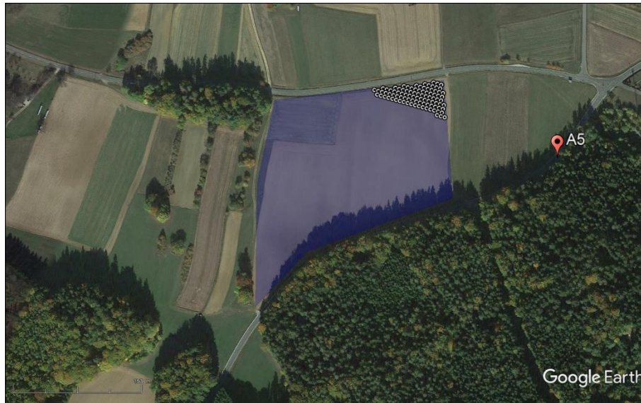
Abbildung 16: Spezifischer Emissionsbereich für Punkt A5 auf der Bundesstraße (Modulneigung 20°)
