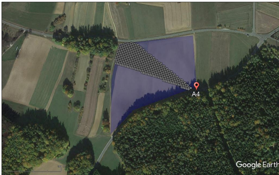
Abbildung 15: Spezifischer Emissionsbereich für Punkt A4 auf der Bundesstraße (Modulneigung 20°)
